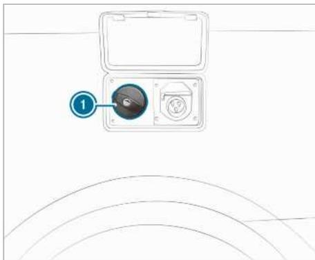
La tubulure de remplissage pour le réservoir d'eau propre **1** se trouve derrière la trappe de maintenance dans la zone arrière, côté conducteur.
