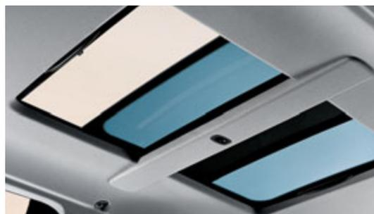
Toit ouvrant/releable électrique à l'arrière<sup>5</sup>.
