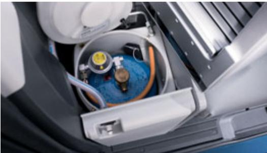
La bouteille de gaz (camping gaz, 2,8 kg) est implantée de façon peu encombrante à l'arrière du véhicule. Pour permettre un accès plus facile, l'arrière du compartiment de rangement placé au-dessus de la bouteille de gaz a été conçu comme un placard rotatif.
