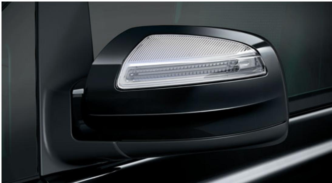
Rétroviseur extérieur avec champ de vision accru, rappel de clignotant intégré et réglage électrique.
