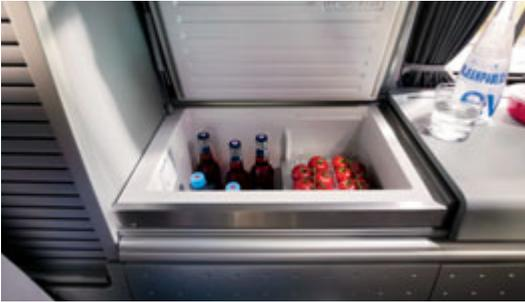
Fraîcheur garantie : très silencieuse, la glacière à compression de 40 l \*\*\* fonctionne au gaz ou à l'électricité (12 V/220 V).
