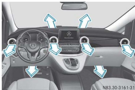
Chauffage en marche
