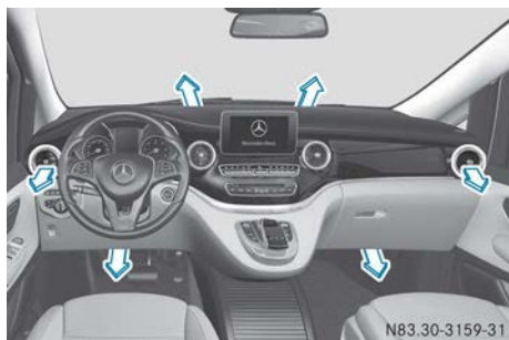
Chauffage en marche
