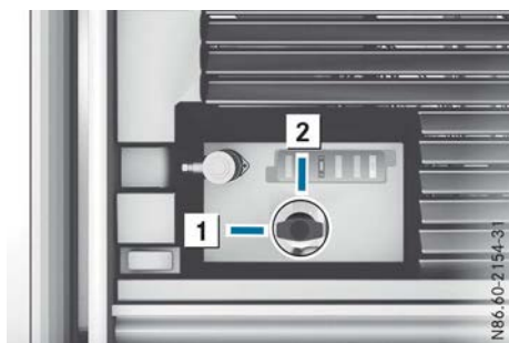
Vanne d'arrêt du gaz
