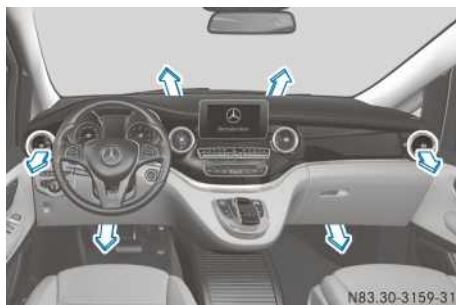
Chauffage en marche
