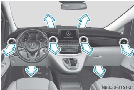
Chauffage en marche
