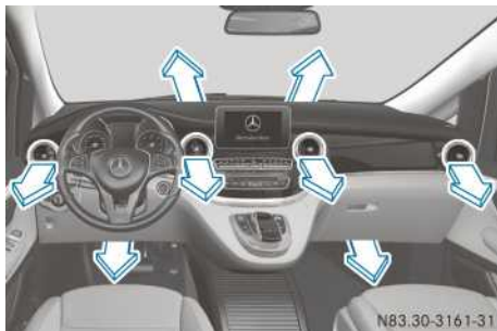
Chauffage en marche
