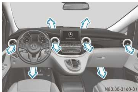
Chauffage en marche
