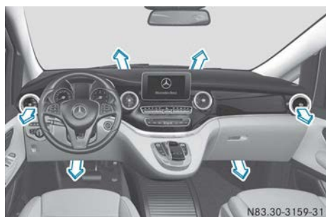
Chauffage en marche
