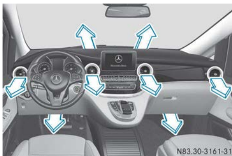
Chauffage en marche
