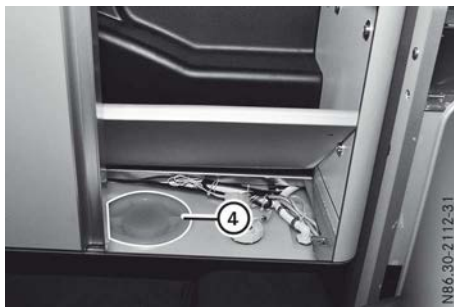
Orifice de nettoyage du réservoir d'eau propre
