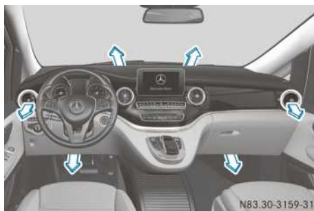
Chauffage en marche
