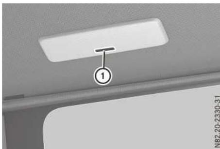
Les ampoules LED sont montées sur les 2 côtés du véhicule, entre les montants B et les montants C, dans le cadre du toit. Les 2 ampoules LED sont enclenchables automatiquement et manuellement. Vous pouvez en outre moduler l'intensité lumineuse des ampoules LED sur 3 niveaux.
