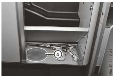
Orifice de nettoyage du réservoir d'eau propre
