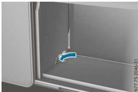
Vous ne pouvez plus fermer normalement le toit relevable à commande électrique suite à un défaut dans le système électrique. Le toit relevable peut néanmoins être fermé par l'intermédiaire d'une commande de secours. La touche d'activation de la commande de secours se trouve dans le placard situé sous le réchaud à gaz, derrière la paroi latérale gauche.
