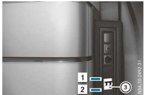
Interrupteur de protection contre les courants de défaut et prise 230 V
