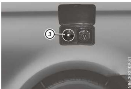
La tubulure de remplissage pour le réservoir d'eau propre ③ se trouve derrière la trappe de maintenance dans la zone arrière, côté conducteur.
