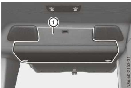
Le compartiment de rangement au niveau du toit ① se trouve dans la zone arrière. Le couvercle est sécurisé par un dispositif de fermeture.
