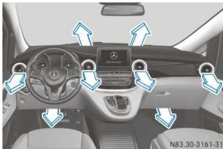
Chauffage en marche
