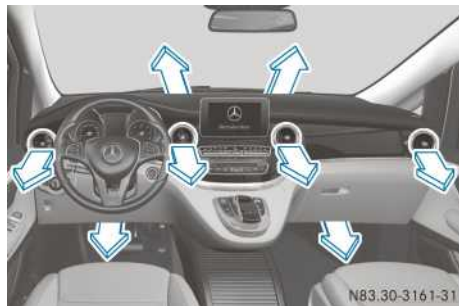
Chauffage en marche
